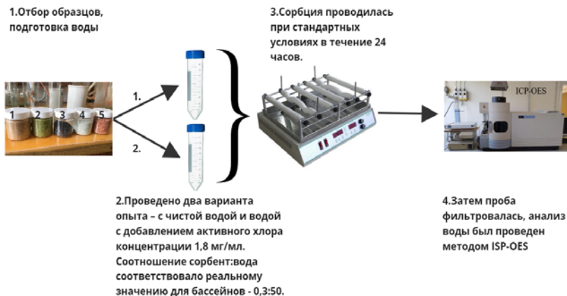
Рисунок 1. Схема проведения эксперимента анализа сорбционной способности для широкого спектра элементов
